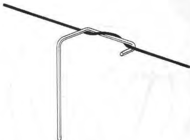
Figura 45. — Para desplazar la aguja del dial y del hilo de mando, debe sujetar con los dedos de una mano el hilo y con los de la otra mover la aguja sin que gire el tambor.
